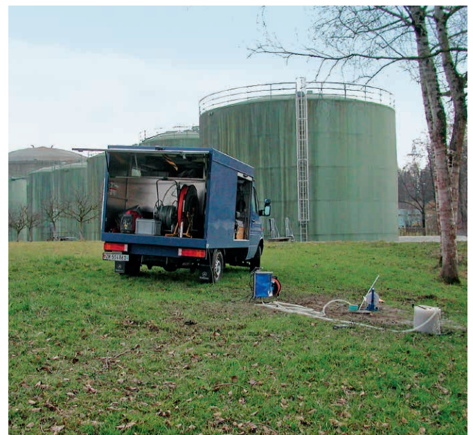
Abb. 22 Probenahme von Grundwasser auf dem Gelände der ersten inländischen Erdölraffinerie in Rotkreuz (ZG).
